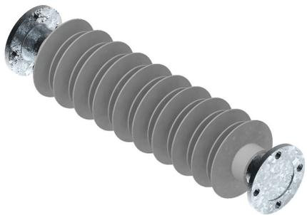
Der GFK-Stab der RPS Isolatoren ist mit hochwertigem grauem Silikon ummantelt. Die Armaturen sind aus verzinktem Stahl. Alle Verbundisolatoren sind nach DIN EN 62621 bauart- und typgeprüft.
